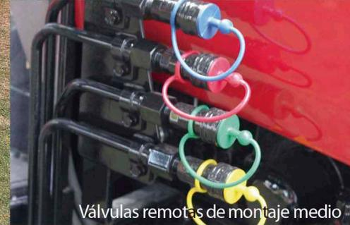
Válvulas remotas de montaje medio
